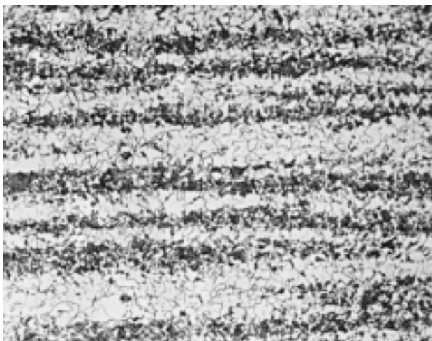
Slika 2: Isti material v valjanem stanju. Pov. 100-kratna
