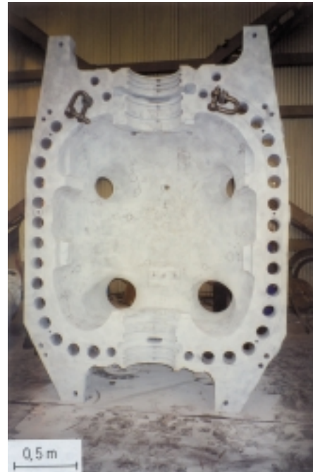
Slika 4: Makroposnetek notranje površine spodnje polovice okrova z označenimi poškodbami
