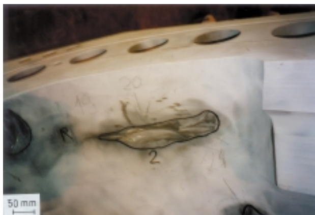
Slika 5: Makroposnetek področja izbrušene večje razpoke Figure 5: Macro image of ground area at larger failure
