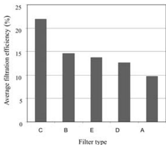
**Figure 5:** Filtration efficiency by type of filter**Slika 5:** Učinkovitost za vsak preizkušen filter
