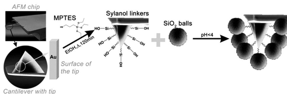
**Figure 2:** Preparation scheme for gold-coated AFM tips**Slika 2:** Shema funkcionalizacije z zlatom obloženih AFM-konic
