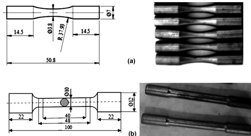
**Figure 1:** Dimensions and images of test specimens: a) fatigue, b) tensile test**Slika 1:** Mere in posnetki preizkušancev: a) utrujanje, b) natezni preizkus
