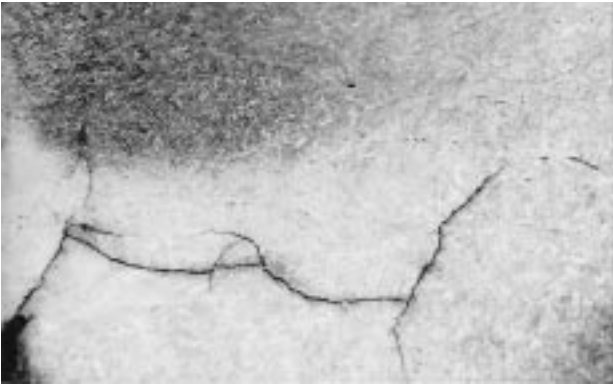
Slika 4: Razpoka v martenzito-avstenitni mikrostrukturi Figure 4: A crack in the martensite-avstenite microstructure
