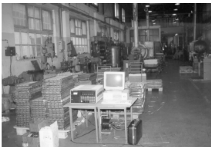
Slika 5: a) Vstop v peč za sintranje in namestitvev oziroma razporeditev termoelementov na transportnem traku ter b) uporabljena merilna oprema med merjenjem temperaturnih profilov na peči za sintranje
