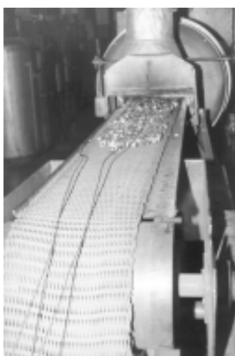
Slika 5: a) Vstop v peč za sintranje in namestitvev oziroma razporeditev termoelementov na transportnem traku ter b) uporabljena merilna oprema med merjenjem temperaturnih profilov na peči za sintranje
