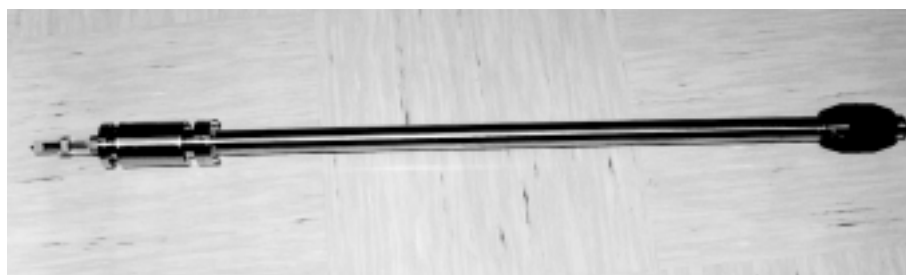
Slika 2: Magnetni rotacijski translator za vstavljanje vzorcev iz predkomore v glavno komoro Figure 2: Translator with magnetic drive used for introduction of the samples into the main chamber
