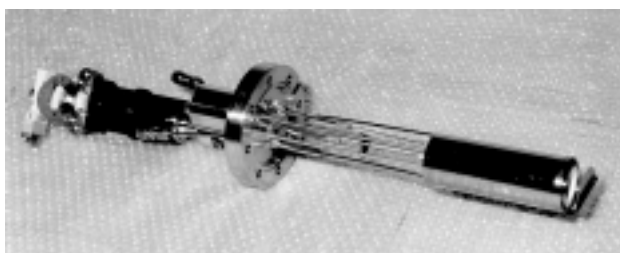
Slika 3: Nizko-temperaturna Knudsenova celica, ki se uporablja kot izvor za rast organskih polprevodnikov
