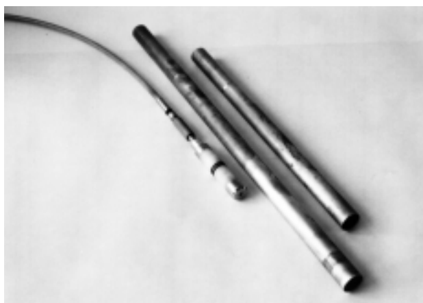
Slika 1: Sonda in etaloni, ki se uporabljajo pri preiskavi cevi z notranje strani
