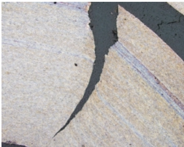
Slika 2: Izceje v toplotno obdelanem, poboljššanem izdelku Figure 2: Segregations in the quenched-and-tempered piece
