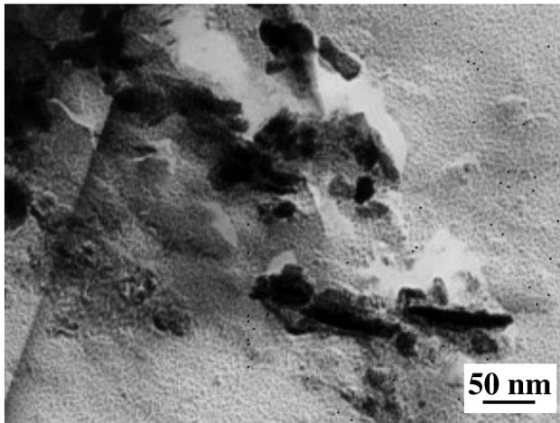
**Slika 9:** TEM-posnetek igličastih nitridov blizu površine, koloidna replika
