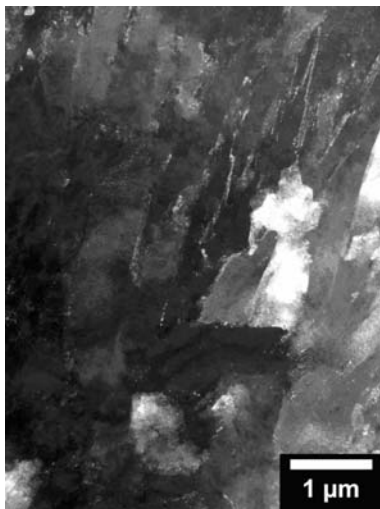
Figure 11: Blade No. 344, fine precipitates displayed in dark field Slika 11: Lopatica št. 344, izločki, prikazani v temnem polju
