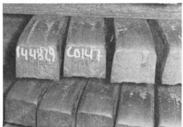
Globina mehurjev 30 do 40 mm hitrost vliwanja 19,17,15 cm/min
